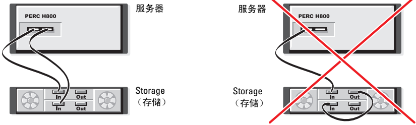
图 4-18. 一个存储柜的冗余路径支持配置
